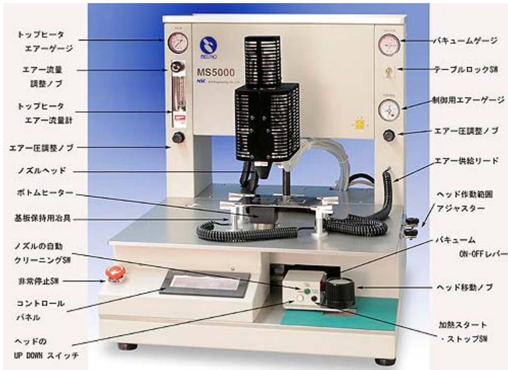
高い温度下でのランドクリーニングは、作業者の熟練に頼らず、誰でも容易に、しかも正確で素早い作業が求められます、MS5000 では、独自開発の高温樹脂製ビットがランド上を定圧で移動し、溶けたはんだを吸い取ります、基板を過熱することなく素早い作業ができますので作業者の能力差がでません。
